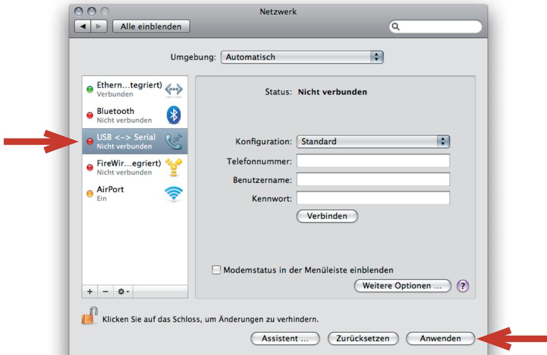
2.4 La nouvelle interface est maintenant installée, appuyez pour finir sur «Appliquer».
