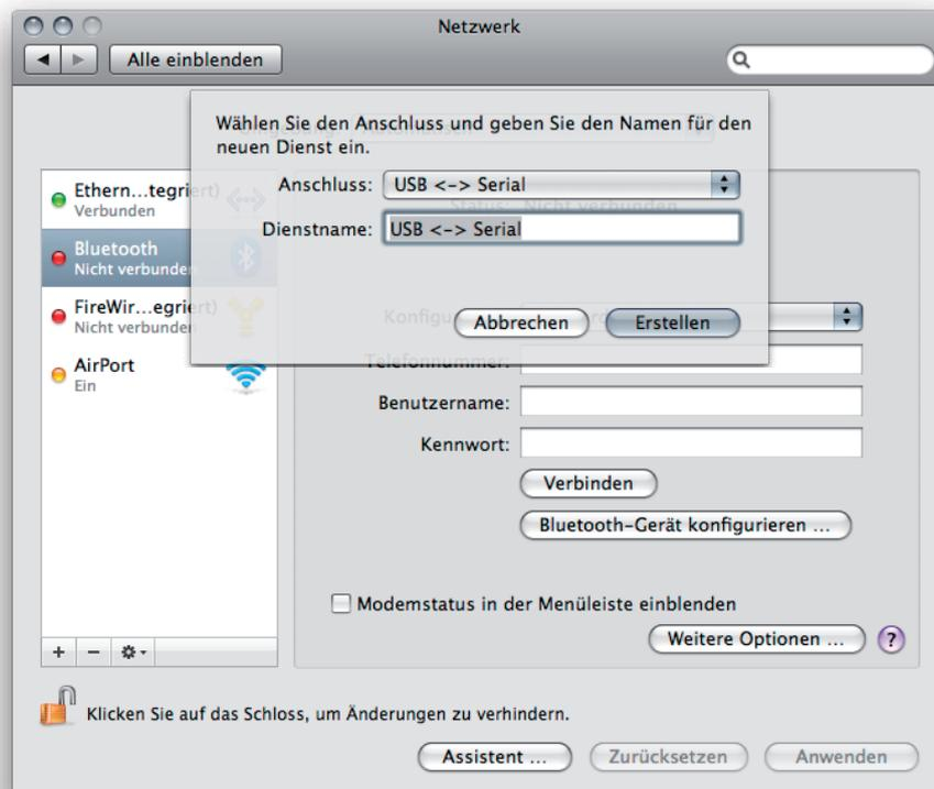
2.3 Sélectionnez la nouvelle connexion «USB < - > Serial» et cliquez sur «établir».
