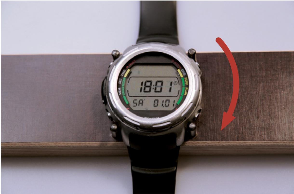
14.0 Remontez la lunette sur le boîtier de la montre. Faites attention à respecter une position vraiment horizontale avant d'engager le pas fin du filetage.
