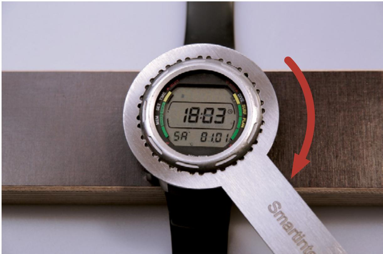
14.2 Insérez la clé sur la lunette, les dents doivent s'emboîter et la clé doit être bien horizontale.
