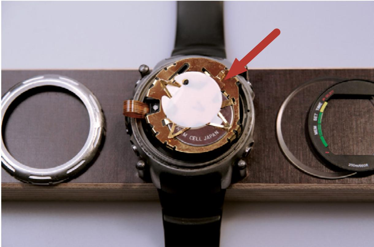
6.1 Retournez l'élément montre sur le boîtier, manipuler avec précaution le circuit imprimé souple.
