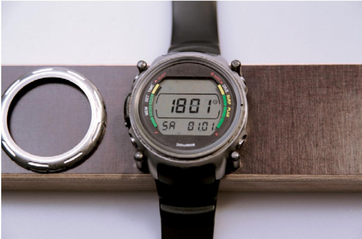
12.0 Remontez la couronne des indications de fonctions en plastique. Vérifiez la position et la propreté du joint torique dans sa gorge circulaire.
