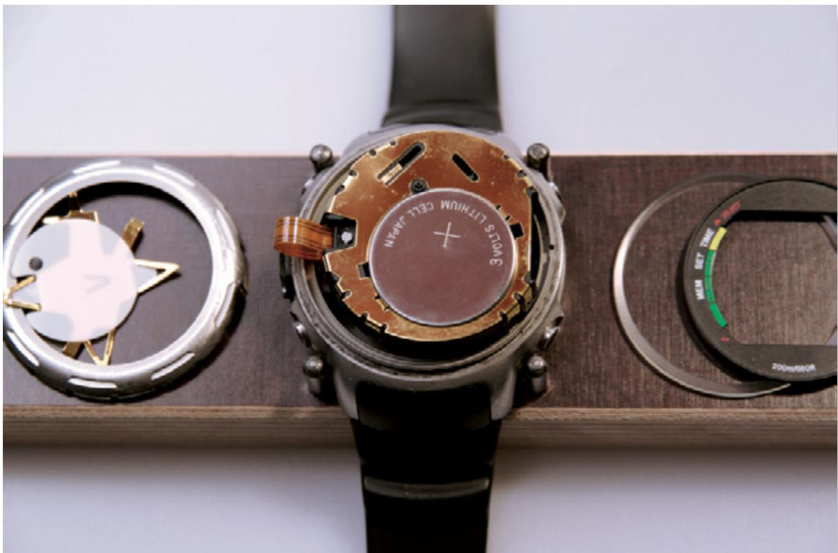
8.2 Nettoyez la pile neuve avec un tissu sec avant de l'installer dans son logement. Respectez la polarité, le positif visible au dessus.
