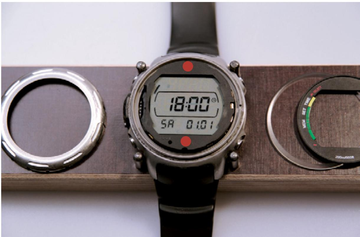
10.1 Positionnez l'élément montre dans le boîtier.
