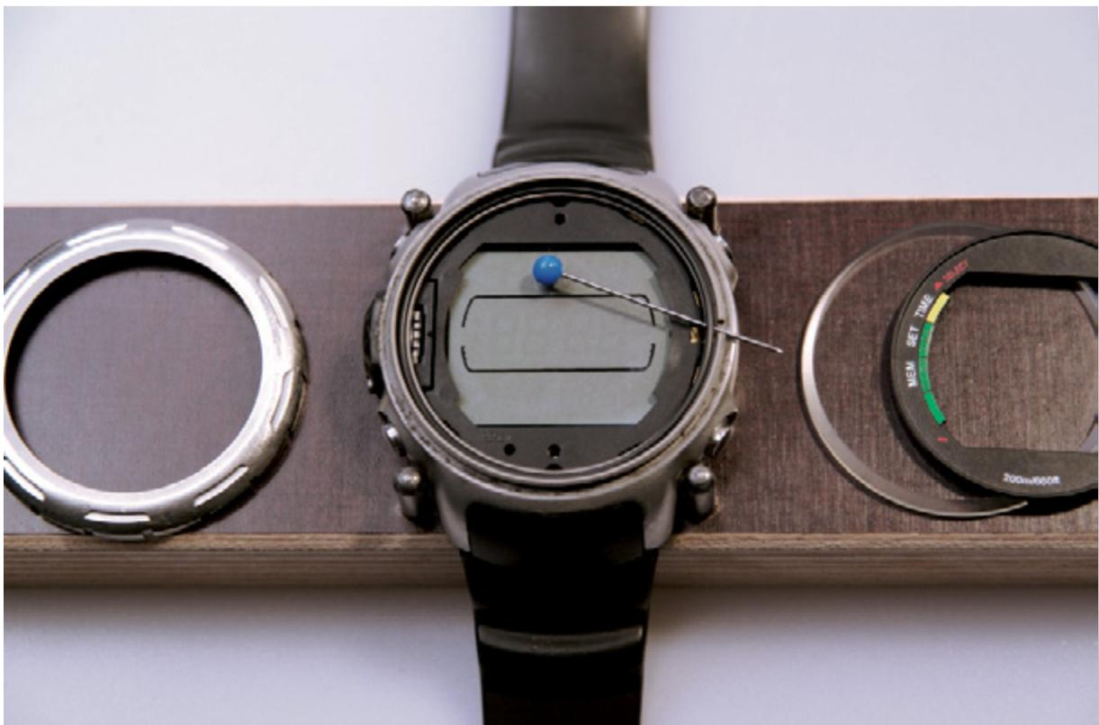
5.0 Soulevez le joint torique usagé avec l'épingle ou simplement en soufflant de coté sur le joint.
